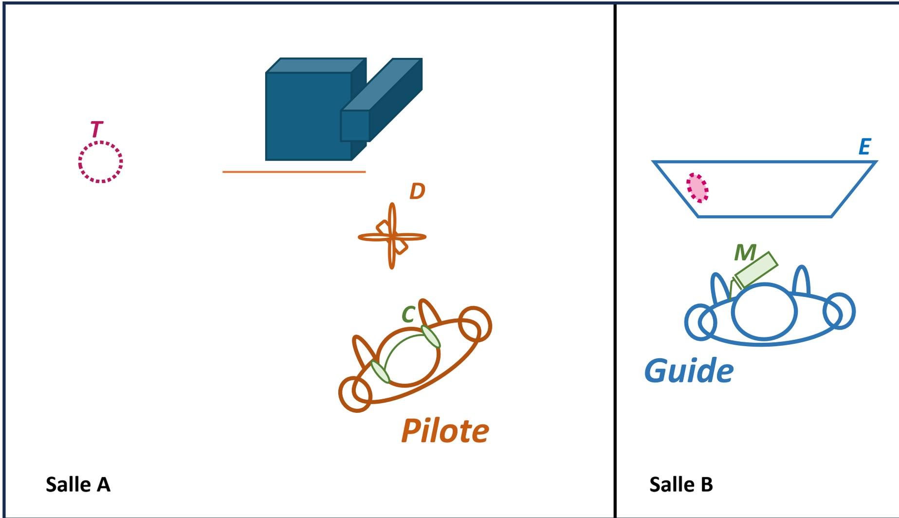
Illustration du projet Voicestick, vue de haut. Dans la salle A se trouvent le pilote avec son drone D et une cible virtuelle (T) invisible pour lui mais à atteindre. Le pilote porte un casque (C) pour recevoir les commandes du guide. Ce guide est dans la salle B, équipé d'un micro (M) et placé face à un écran (E). Sur cet écran, il peut voir la cible dans l'espace capté par la caméra du drone.
